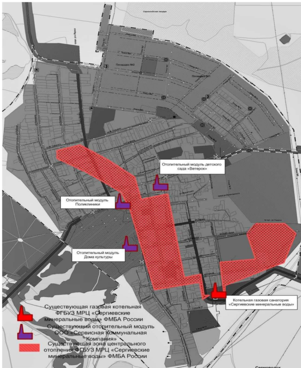
Рисунок 8 – Источники тепловой энергии с. Серноводск
