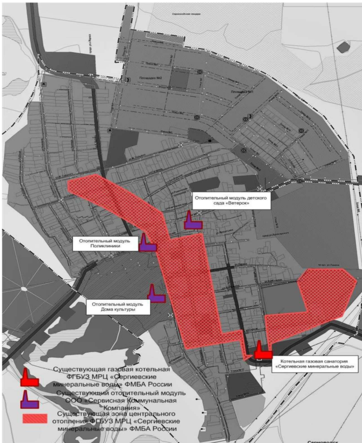
Рисунок 8 – Источники тепловой энергии с. Серноводск
